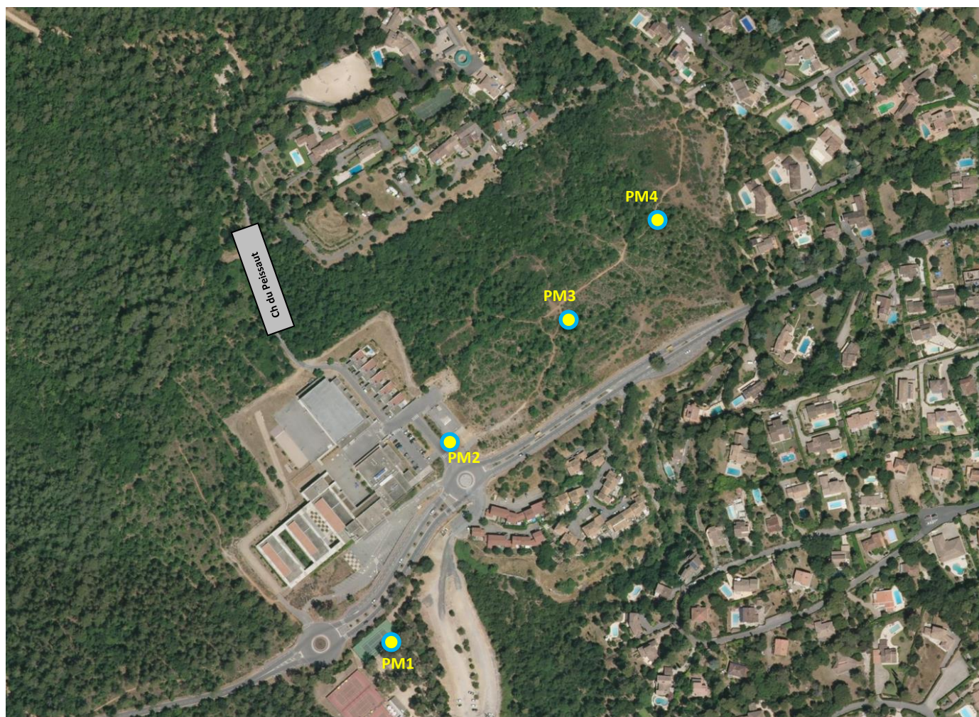
Illustration 3 : Localisation des points de mesure de la qualité de l'air
