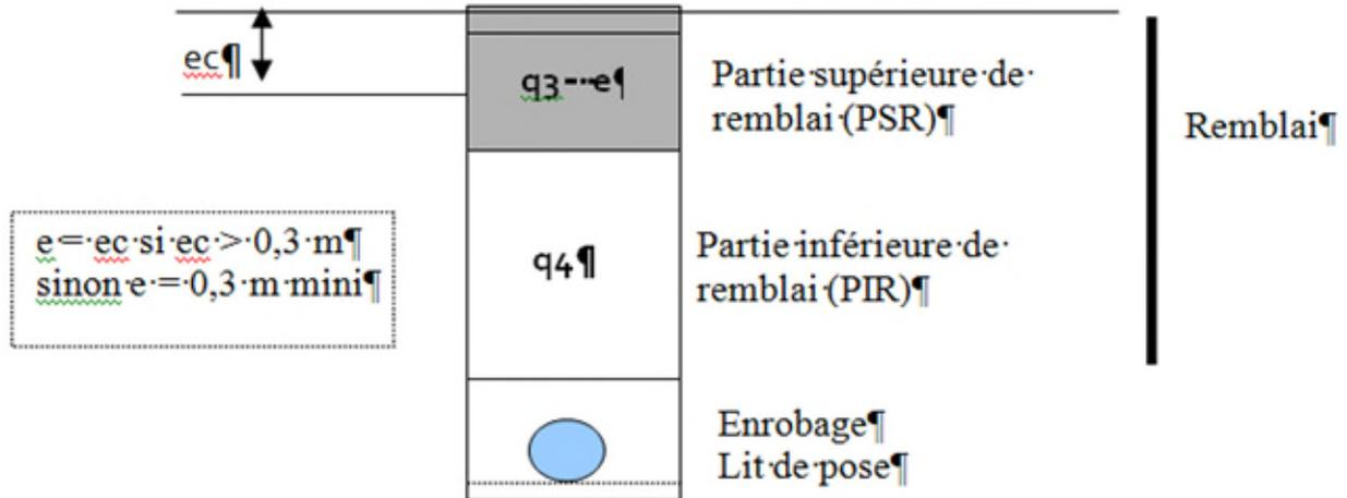
Fig. 6: Coupe type d'une tranchée sous accotement
